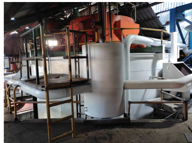
Nuevo Sistema de Alimentación de Jugo en el Clarificador de Jugo.
