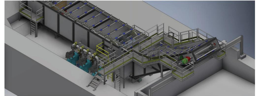
Ilustración del nuevo sistema de captación de cenizas instalado en el CAC.
